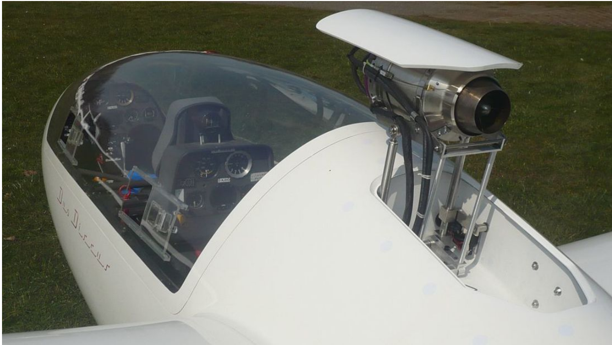
Afbeelding 10-3 Turbinemotor op een zweefvliegtuig (Duo Discus)
