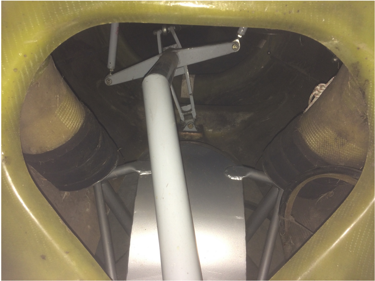
Afbeelding 5-5 Stuurstang uitgevoerd als torsiebuis tbv rolroeren en hoogteroer (ASK-21)
