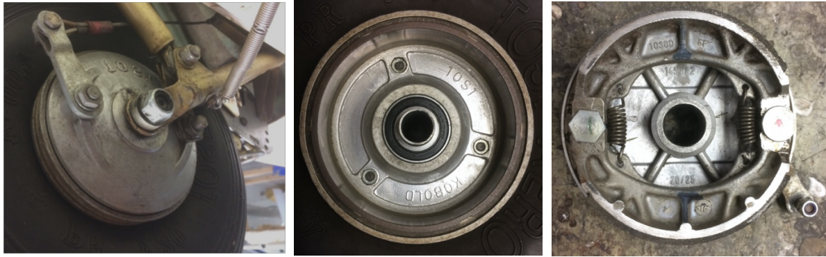
Afbeelding 3-5 Trommelrem (LS4): links gemonteerd, midden de trommel, en rechts de remvoeringen.
