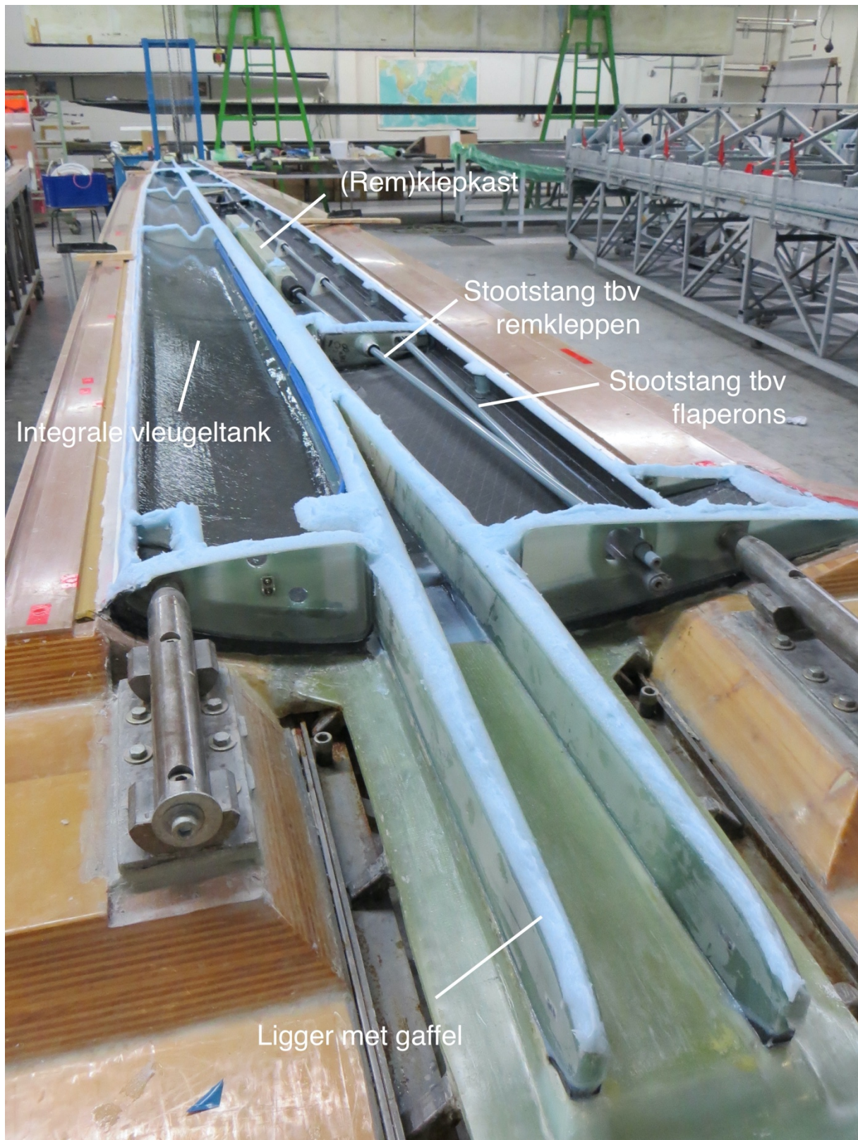
Afbeelding 1-7 Constructie kunststof vleugel (LS10-st)
