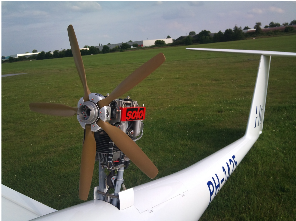
Afbeelding 10-2 Zuigermotor op een zweefvliegtuig (Ventus 2cxt)
