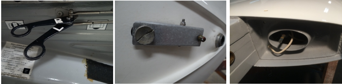
Afbeelding 11-2 De cockpithendel(s) bedienen een tuimelaar in de romp welke via een stang de kraan in de vleugel open duwt
